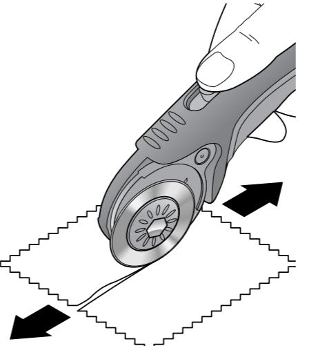
Klingenschutz vorschieben • Enabling the blade protection • Faire avancer le protège-lame • Stažení ochrany čepele směrem dopředu • Przesuwanie osłony ostrza do przodu • Zapnute ochrany čepele • Pengevédő előretolása • Biçak korumasını öne çekmek
